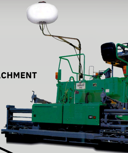
MULTIQUIP GLOBUG LIGHTING SYSTEMS
